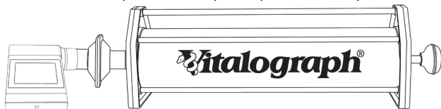
Figure 3 : micro-dispositif connecté à une seringue de 3 litres
