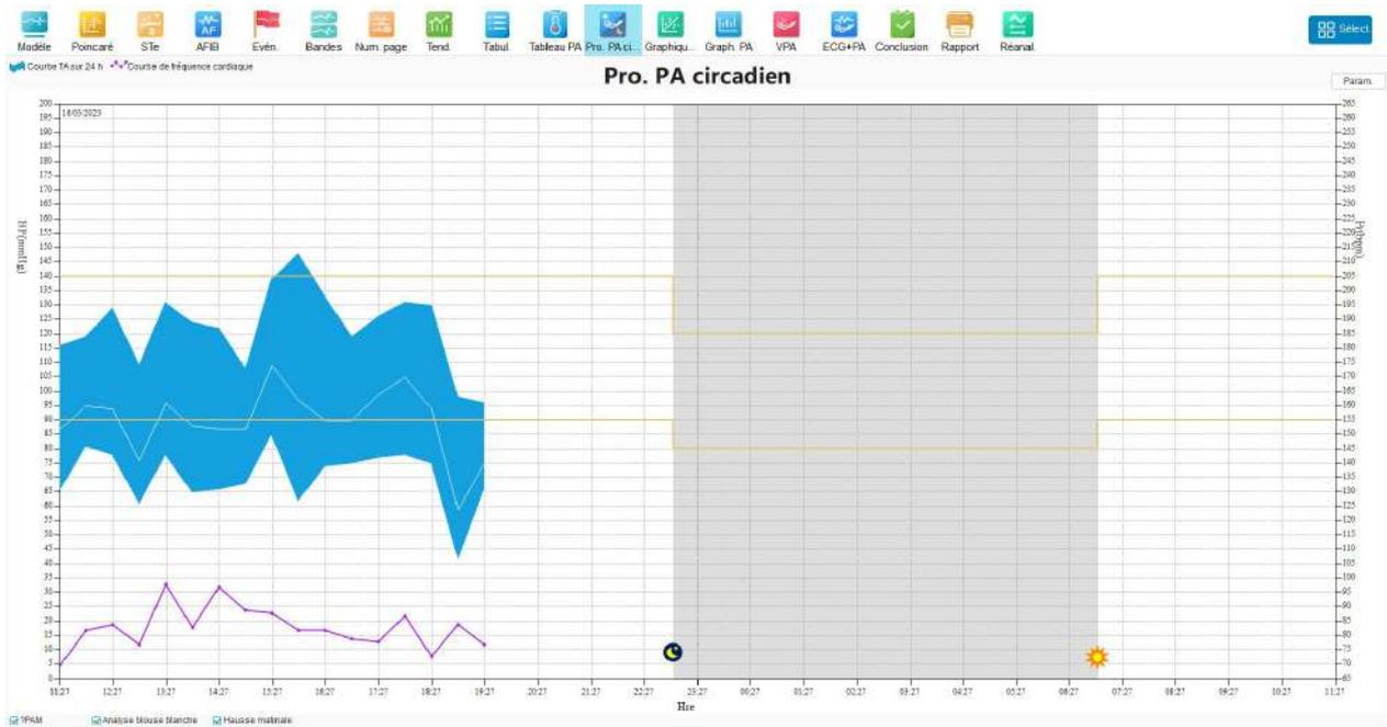
Dans ce profil, l'axe X affiche l'heure au format 24 h. L'axe Y indique la tension artérielle (en mmHg) à gauche et la fréquence du pouls (en bpm) à droite.
