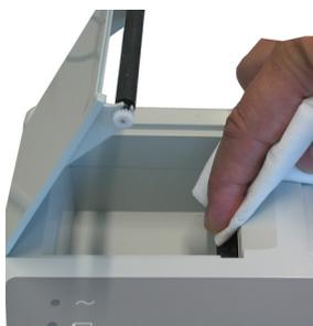
Avec le temps, un résidu d'encre provenant du quadrillage du papier peut s'accumuler sur la tête d'impression thermique. et nuire à la qualité d'impression. Il est donc recommandé de nettoyer la tête d'impression tous les mois avec de l'alcool, en procédant comme suit :
